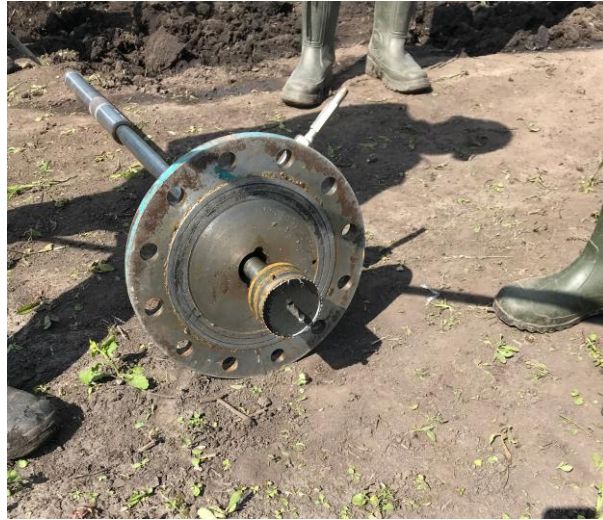
Рис. 4. Демонтований ручний свердлильний механізм T-101bXL з вирізаним елементом (купоном)
