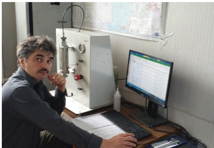
Рис. 5. Процес виміру абсолютної газопроникності по зразках керна на приладі GASPERM, Vinci, Франція
