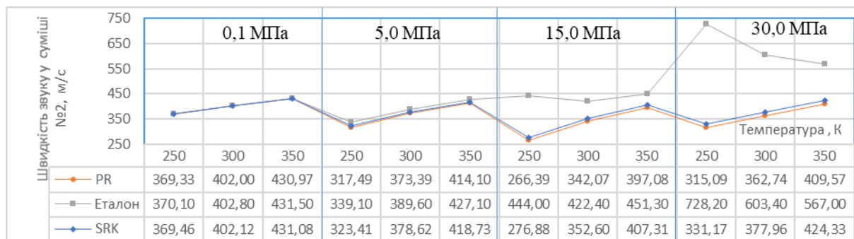
Рис. 5. Залежність швидкості звуку у суміші № 2 від температури та тиску
