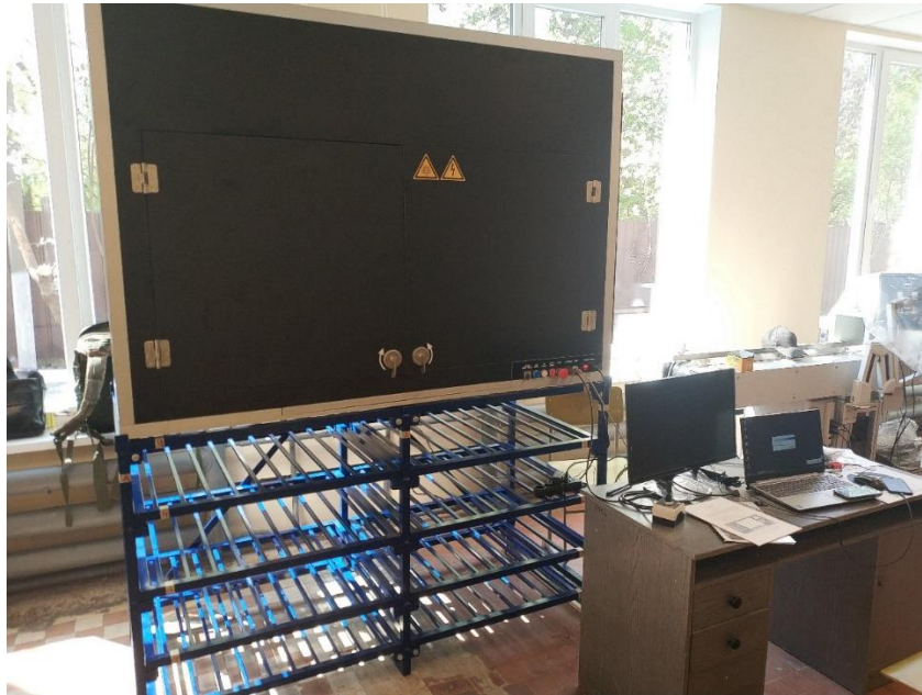
Рис. 6. Зовнішній вигляд цифрової установки для фотографування керна в білому та ультрафіолетовому світлі, GEOFACTORY, Іспанія
