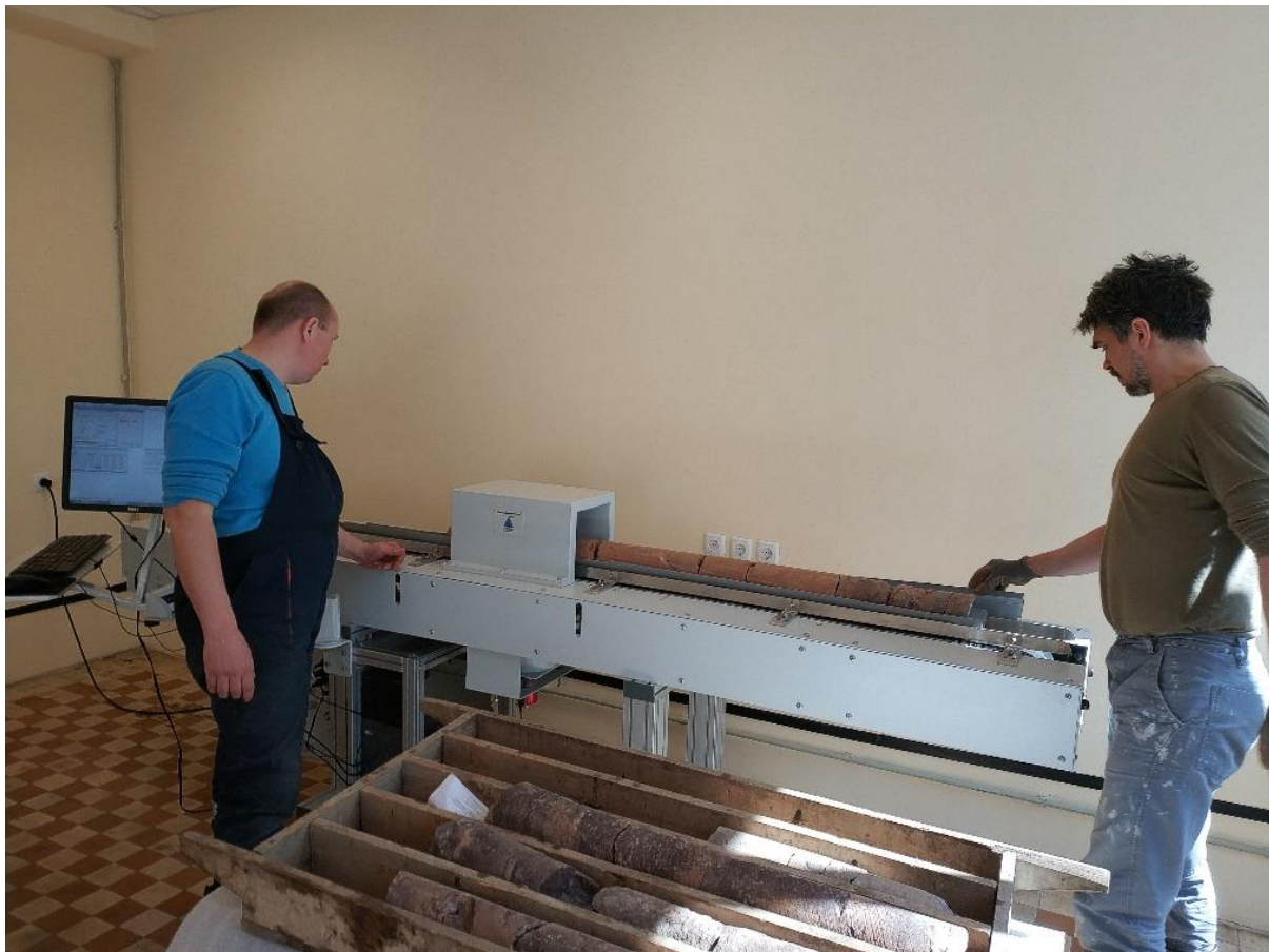
Рис. 2. Процес запису кривої ГК по повнорозмірному керну на приладі SGL-301 Corelab, США
