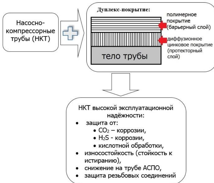
Рис. 3. Схема одержання НКТ високої корозійної стійкості й експлуатаційної надійності
