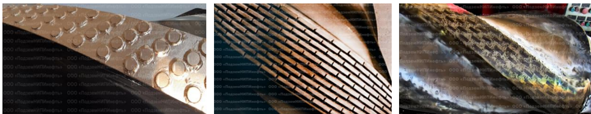
Рис. 2. Варіанти розміщення вставок на лопатях калібраторів (зліва-направо): ряди круглих наплавок впоперек; вставки рядів поздовжніх пластин; вставки пластин "шахівницею" [1, 2]
