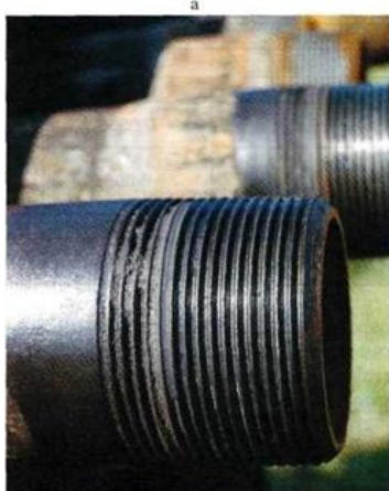
Рис. 1. Зовнішній вигляд різьбового (ніпельного) кінця НКТ після промислових випробувань у нафтовій свердловині протягом 5 років і 5 міс.
